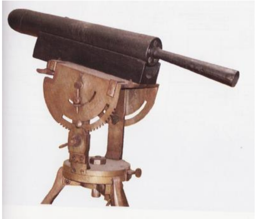
Razzi di tipo "Congrève" inglese con bacchetta centrale, fabbricati a Torino per l'esercito sabauda A destra: cavalletto per lo sparo dei razzi
